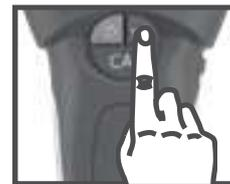
**AC-SCAN:** Localisation de lignes sous tension jusqu'à 2 cm directement sous des revêtements non métalliques.
