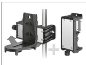
За допомогою затискного кронштейна (6) настінний тримач може бути встановлено на профілі для гіпсокартону в горизонтальному або вертикальному положенні.
